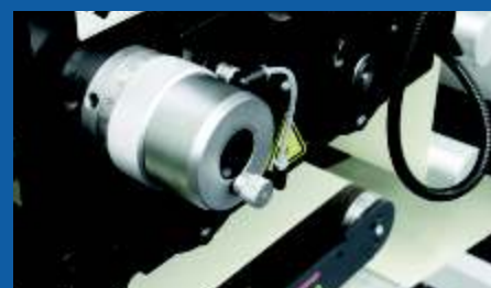
System regulacji prze witu GapMaster
