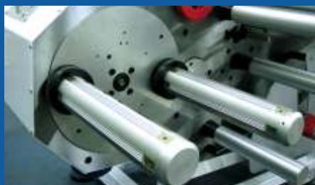
Nawijak w wersji semi-turret z opcją jednoczesnego nawijania na obu trzpieniach
