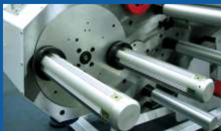
Nawijak w wersji semi-turret z opcją jednoczesnego nawijania na obu trzpieniach
