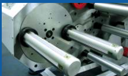
Nawijak w wersji semi-turret z opcj jednoczesnego nawijania na obu trzpieniach
